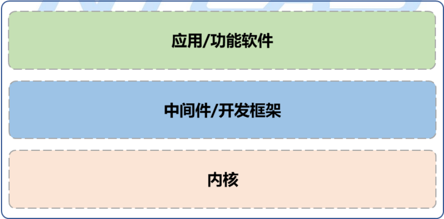
图 6 智能驾驶操作系统纵向分层示意图
