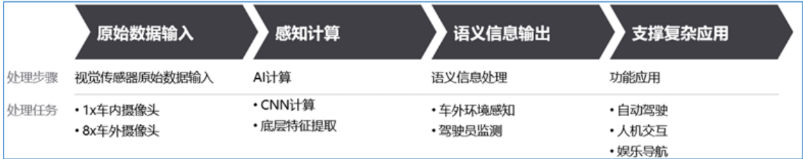
图 10 Tesla Autopilot 数据流处理机制
