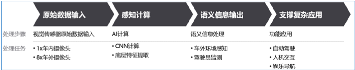
图 10 Tesla Autopilot 数据流处理机制
